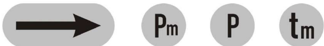
Рис.15. Обозначение направления потока газа, мест отбора давления и температуры газа на главном корпусе счетчика.
